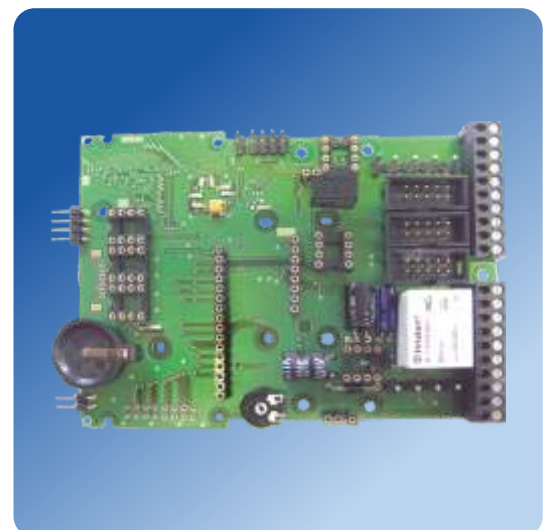
A0756 - ZIF BUS, Kopplung der Zentrale mit dem Bus
