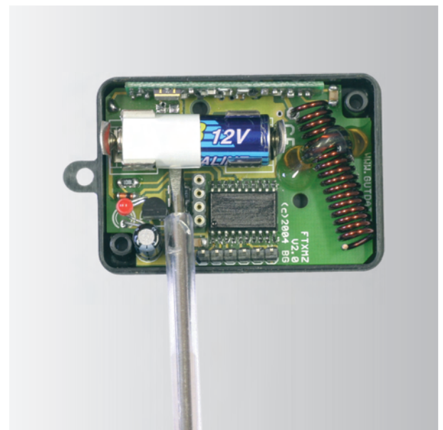
Abbildung: Mit dem Schraubendreher wird die Batterie heraus gehobelt
